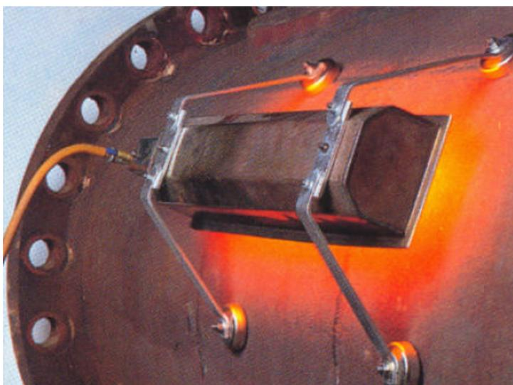
**Infrarot-Gasstrahler am Behälter**
