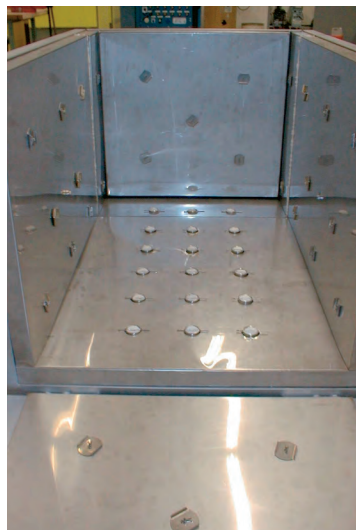
Caissons de chauffage préalable et de trempe pour le réchauffement préalable et le recuit de détente d'outils et les matrices d'estampage
