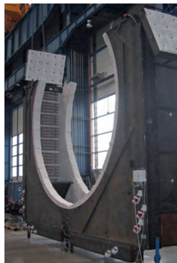
Fourneau circulaire à chauffage électrique
