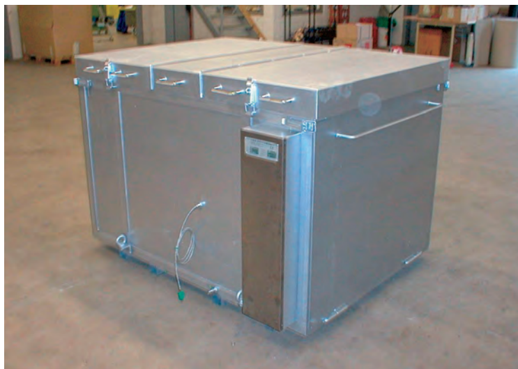
Caissons de chauffage préalable et de trempe pour le réchauffement préalable et le recuit de détente d'outils et les matrices d'estampage
