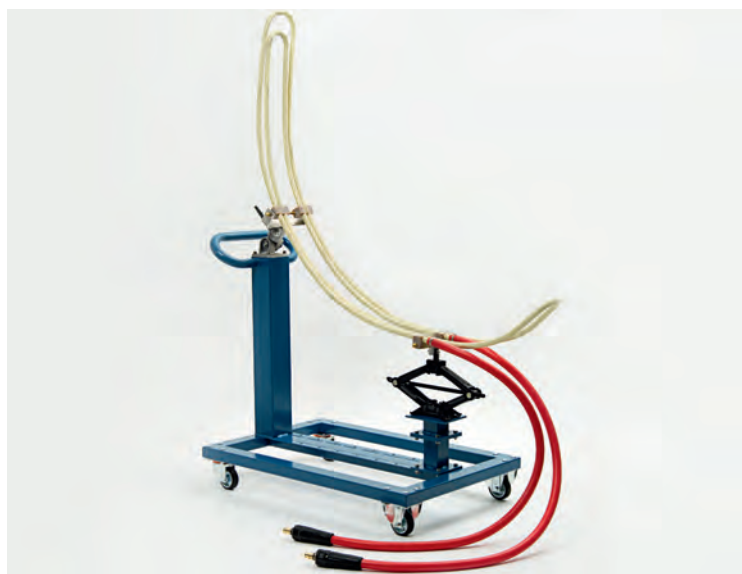
Positionneur avec inducteur rigide
